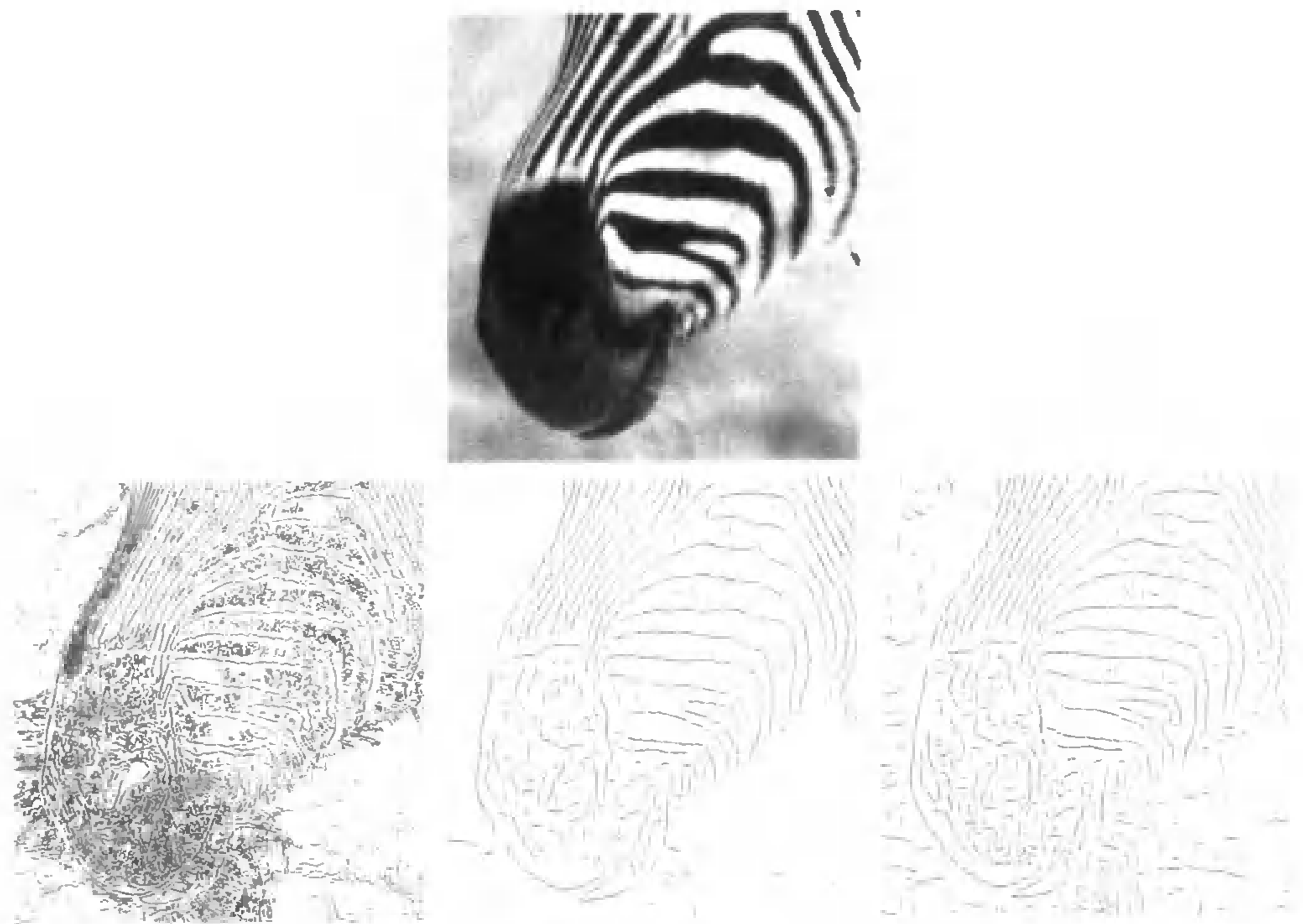
图 8.14 图示中,上面的图按照相应的像素栅格将边缘点标出。左下图的边缘点是用 \sigma 为一个像素的高斯平滑器对图像进行高斯平滑得到的,并且用一个很高的阈值去检测梯度值的大小以确定某一个点是否边缘点。中下图上的边缘点是用 \sigma 为 4 个像素的高斯平滑器对图像进行高斯平滑得到的,并且用一个很高的阈值去检测梯度值的大小以确定某一个点是否边缘点。右下图上的边缘点是用 \sigma 为 4 个像素的高斯平滑器对图像进行高斯平滑得到的,并且用一个很低的阈值去检测梯度值的大小以确定某一个点是否边缘点。用合适的尺度,较好的细节和高对比度可以产生的边缘点,在粗糙的尺度上会消失。当阈值取的很高时,边缘点的曲线经常遭到破坏,因为梯度值往往小于所设的阈值;而对于很低的阈值,会增加各种各样意义不确定的新边缘点
