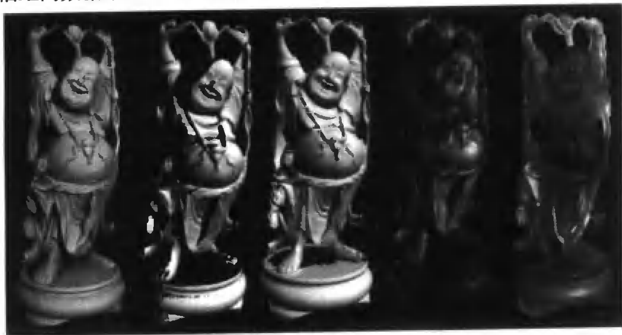
图 21.13 一个佛像的 3D 传真图。从左到右:佛像照片;距离图像;集成的 3D 模型;孔洞填充后的模型;由立体成像得到的物理模型
