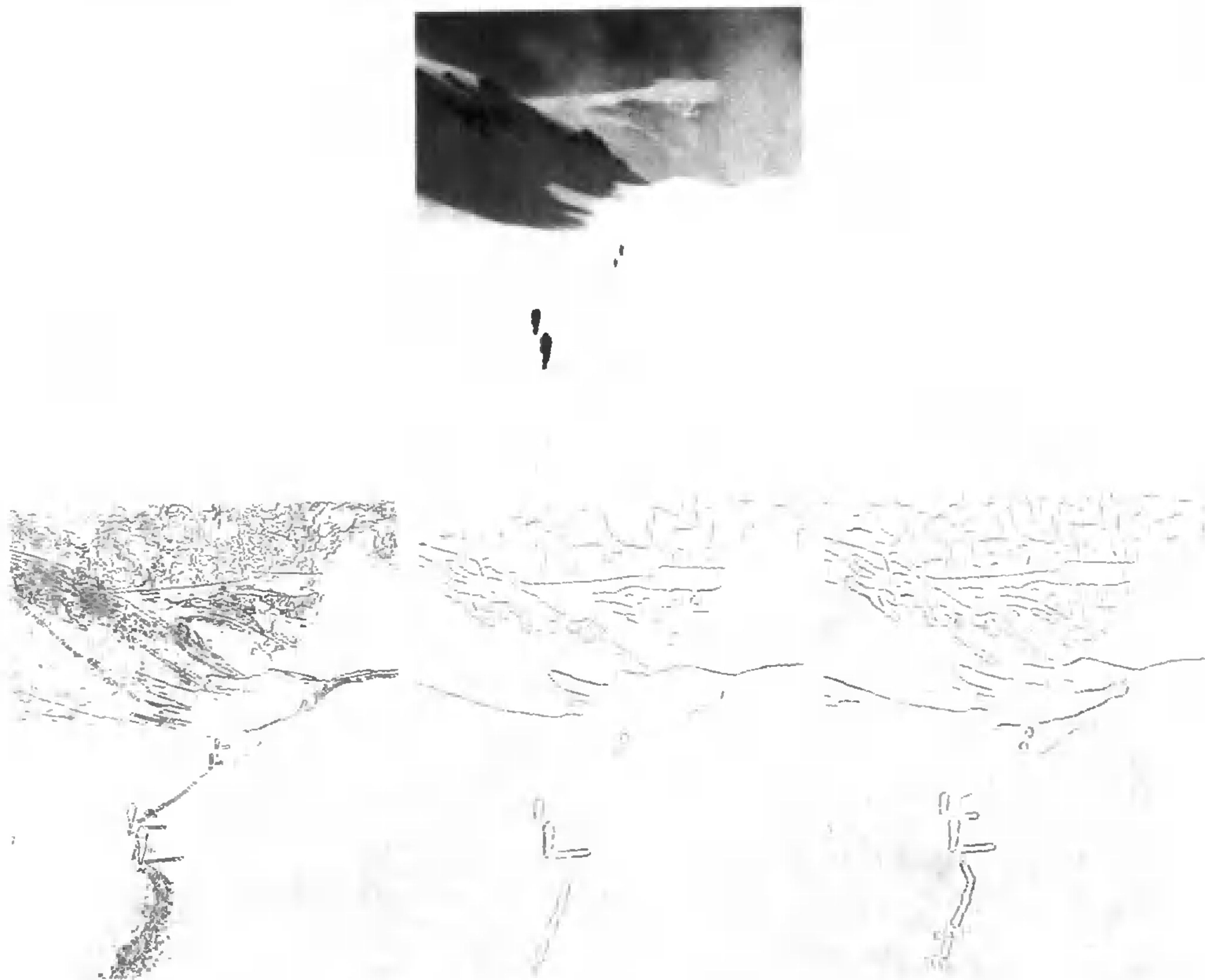
图 8.15 图示中,上面的图按照相应的像素栅格将边缘点标出。左下图的边缘点是用 \sigma 为 1 个像素的高斯平滑器对图像进行高斯平滑得到的,并且用一个很高的阈值去检测梯度值的大小以确定某一个点是否边缘点。中下图上的边缘点是用 \sigma 为 4 个像素的高斯平滑器对图像进行高斯平滑得到的,并且用一个很高的阈值去检测梯度值的大小以确定某一个点是否边缘点。右下图上的边缘点是用 \sigma 为 4 个像素的高斯平滑器对图像进行高斯平滑得到的,并且用一个很低的阈值去检测梯度值的大小以确定某一个点是否边缘点。用细的尺度、高对比度下的细节产生的边缘点,在粗糙的尺度上会消失。当阈值取的很高时,边缘点的曲线经常遭到破坏,因为梯度值往往小于所设的阈值;而对于很低的阈值,会增加各种各样意义不确定的新边缘点
