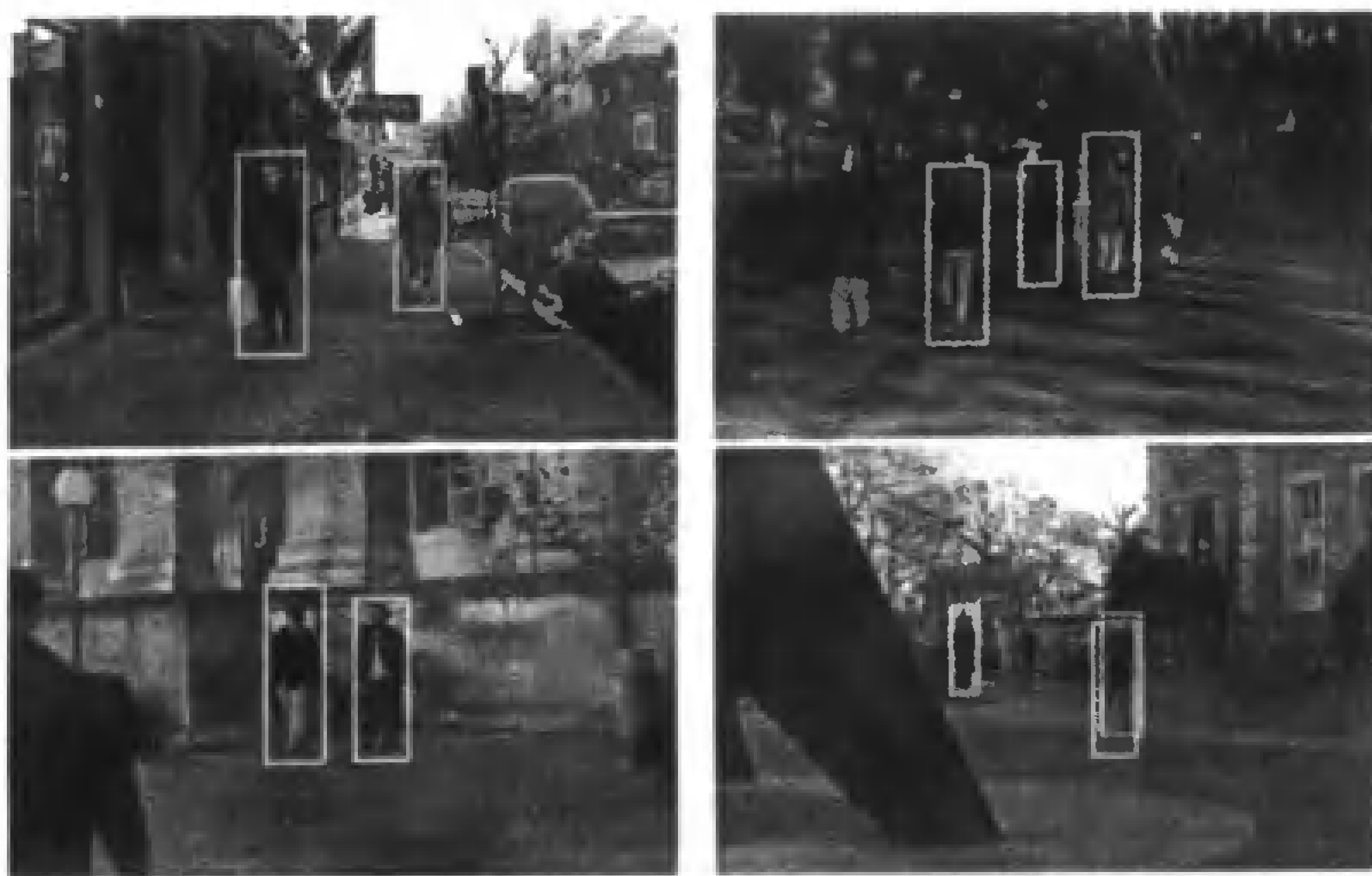
图 22.21 上图给出了利用 Papageorgiou, Oren 和 Poggio 的方法进行行人检测的一些结果,虽然不是所有的引入都检测出来,但可以看出检测率是比较高的,其接受操作曲线如图 22.22 所示
