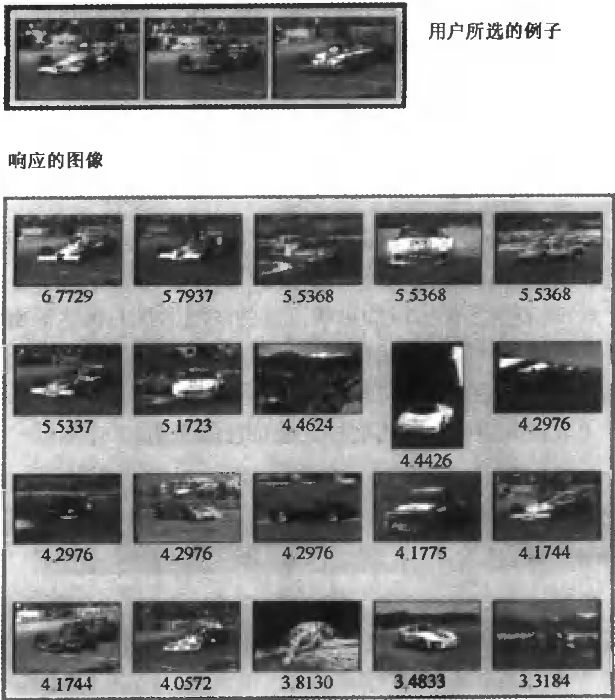
图 25.5 查询使用纹理的纹理方法。用户选了三张汽车照片为正例,它们对大的水平带滤波器响应比其他滤波器强烈。然后该系统随机地选取一些图像(用来表示无关的图像)这些数据用来建立一个分类器来锚列可能有关的其他图片。该查询检得到的图像中包含了若干汽车图像
